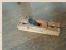
面取鉋 材料の角を取る
