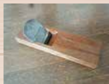
平鉋（寸 6、寸 8 ※1 など） 平面を削る
