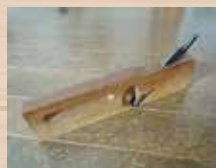
ソコ取鉋 敷居やかまの溝の底を削る
